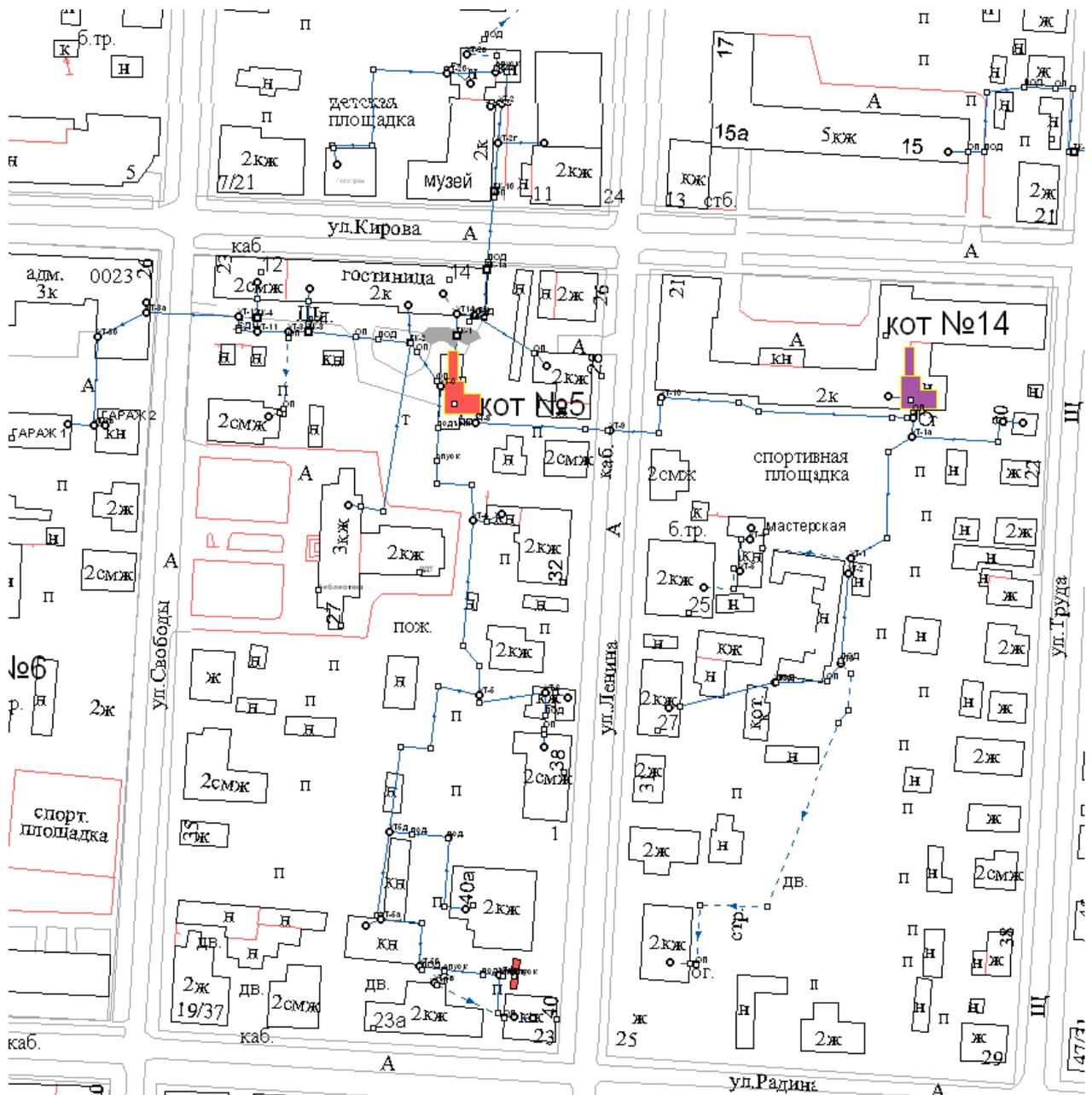
Рис. 2.2.2.3. Зона действия котельной № 5 ОАО «Коммуэнерго»
